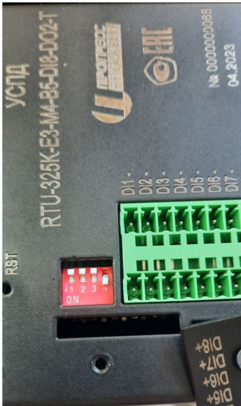
Рис.1.10. Под крышкой S1 расположены 4 переключателя.
